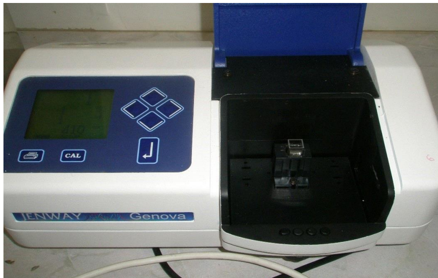
Εικόνα:4.8 Φασματοφωτόμετρο για την μέτρηση της απορρόφησης των δειγμάτων
