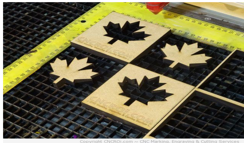
Εικόνα 3.6 Κοπή σε ξύλο 6mm
