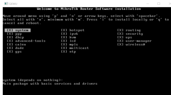
Εικόνα 5-17: Εγκατάσταση λειτουργιών του Router Mikrotik
