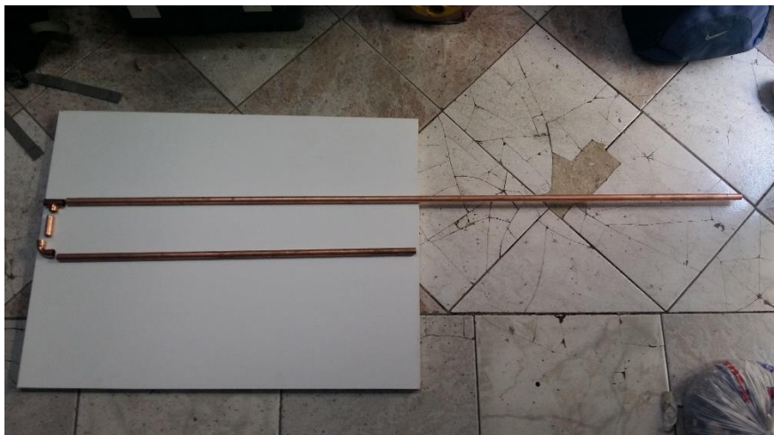
Εικόνα 38 Κομμένα κομμάτια χαλκοσωλήνα πριν την κόλληση
