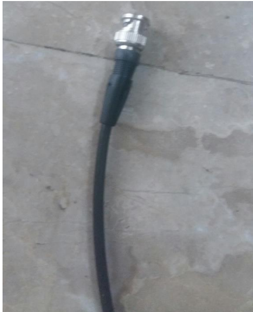
Εικόνα 42 Ένωση συνδέσμου BNC με το ομοαξονικό καλώδιο RG-58
