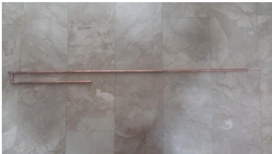
Εικόνα 41 Κόλληση βασικού κορμού κεραίας
