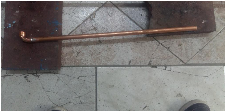
Εικόνα 40 Ένωση γωνίας με τη σωλήνα χαλκού
