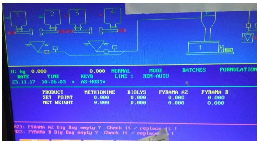
Εικόνα 7: Η οθόνη αυτή του υπολογιστή μας δίνει την δυνατότητα να επεξεργαζόμαστε και να ελέγχουμε τη διαδικασία εισαγωγής της μεθειονίνης, λυσίνης και των άλλων πρόσθετων αλλά και την ποσότητα αυτών. Νούμερα 1,2 είναι οι θέσεις της μεθειονίνης και της λυσίνης και νούμερα 3,4 είναι των πρόσθετων και των προμιγμάτων.
