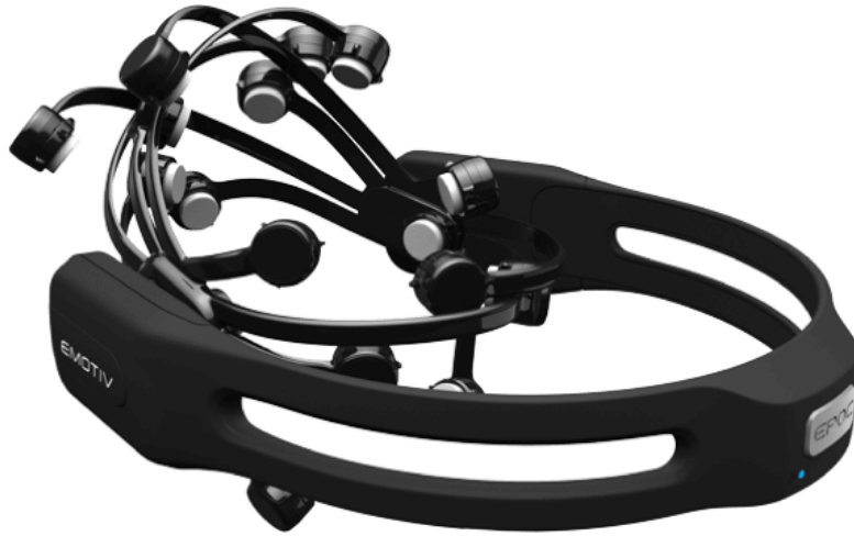
Εικόνα4.3:Η συσκευή καταγραφής ΗΕΓ της Emotivsystems.
