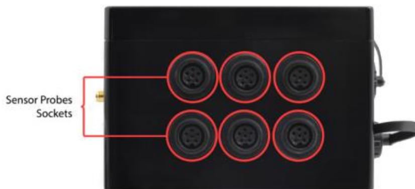
Εικόνα 3.2: Εύκολα προσβάσιμες θύρες αισθητήρων.
