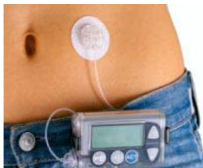
Εικόνα 14 : Εξωτερική αντλία χορήγησης ινσουλίνης (Πηγή: www.medtronic-diabetes.gr )
