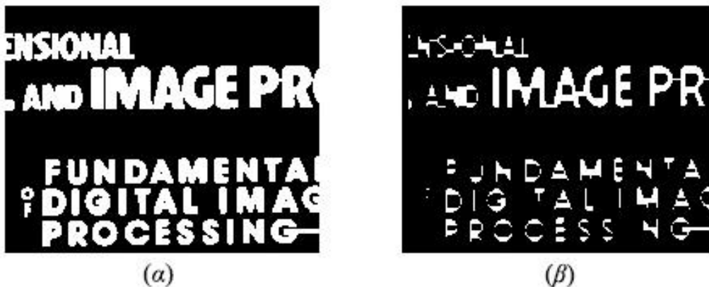
Εικόνα 2.20: α) Αρχική δυαδική εικόνα, β) Μετασχηματισμός hit and miss με επιμηκυσμένο 2 \times 5 δομικό στοιχείο
