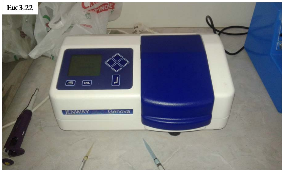
Εικόνα (3.22) : Φασματοφωτόμετρο για την μέτρηση της απορρόφησης των δειγμάτων, σε μήκος κύματος 410 nm.
