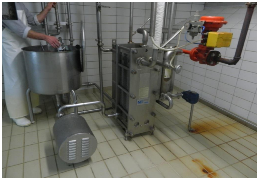
Εικόνα 7. Παστεριωτής του τυροκομείου του ιδρύματος.
