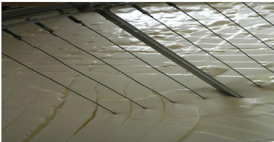
Εικόνα 2 Διαίρεση τυροπήγματος με “κιθάρα”
