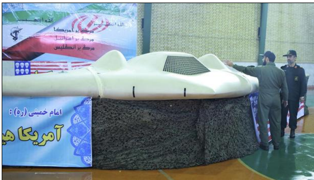
Εικόνα 2.7: Επίδειξη του RQ-170 στο Ιρανικό κοινό. Σημειώνεται ότι το κάτω τμήμα της ατράκτου είναι καλυμμένο πιθανότατα λόγω ζημιών κατά την προσεδάφιση ενώ εμφανής είναι επίσης η ζημία στη δεξιά ρίζα της πτέρυγας. (Πηγή : Gladstone, 2011) .
