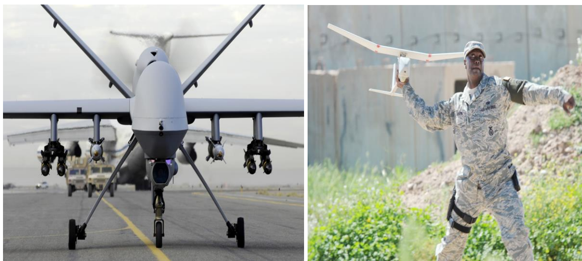
Εικόνα 1.5: Οπλισμένο MQ-9 Reaper (Predator B) κατηγορίας HALE και RQ-11 Raven κατηγορίας MINI κατά NATO. (Πηγή: Military.com, 2017)
