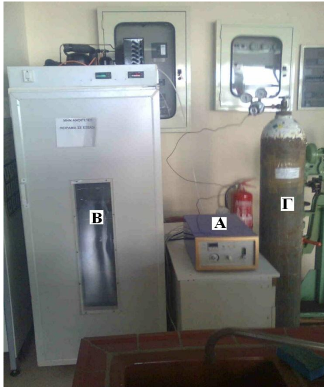
Εικόνα 1. Πειραματική διάταξη οζονισμού.
