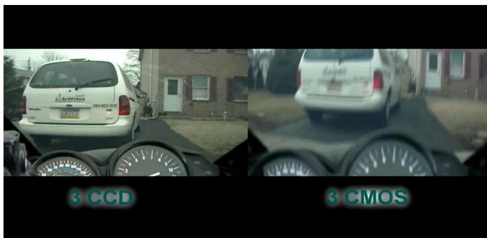
Διαφορά στην ποιότητα εικόνας από κάμερες με αισθητήρες CCD και CMOS σε ίδιο περιβάλλον και ίδιο φωτισμό.
