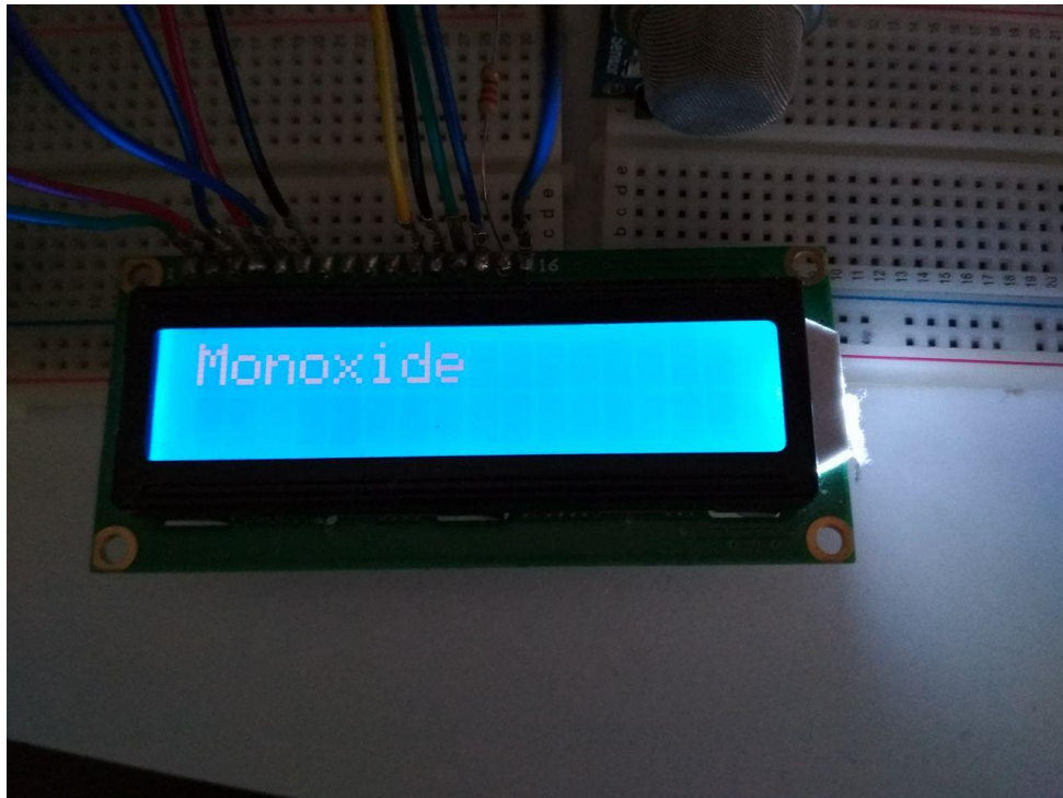
5.15 Προετοιμασία προβολής αποτελεσμάτων μονοξειδίου
