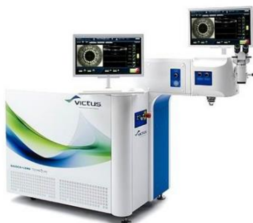
Εικόνα 9- Η πλατφόρμα femtosecond λέιζερ για καταρράκτη VICTUS
