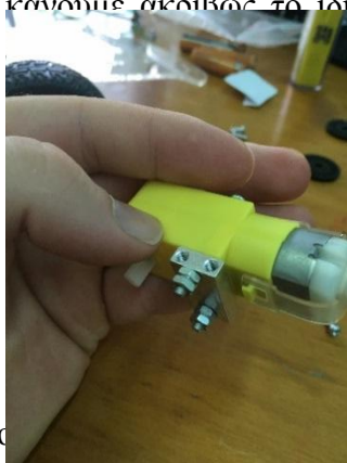
Εικόνα 5.8: Σύνδεση μοτέρ με ρόδες (Δ)
