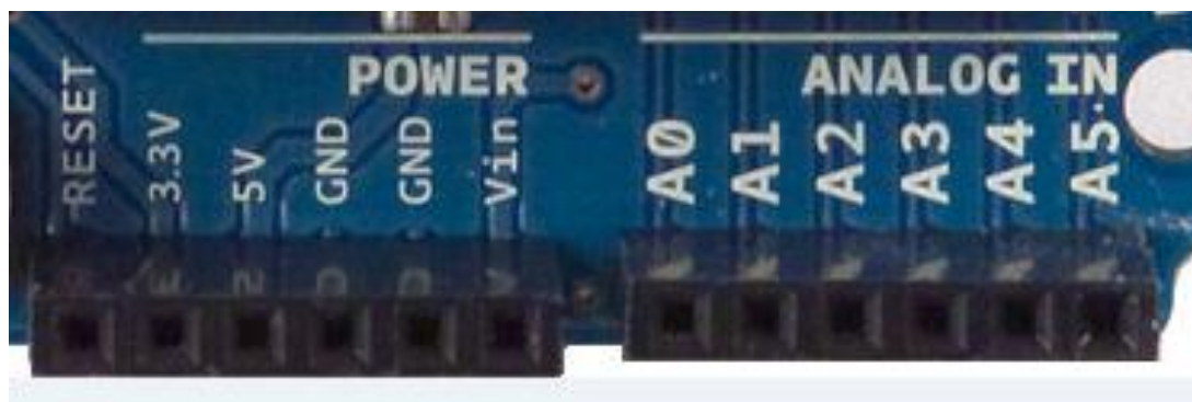
Εικόνα 2.6: Ακροδέκτες τροφοδοσίας power (αριστερά) αναλογική είσοδοι analog in (δεξιά) στην πλακέτα Arduino Uno
