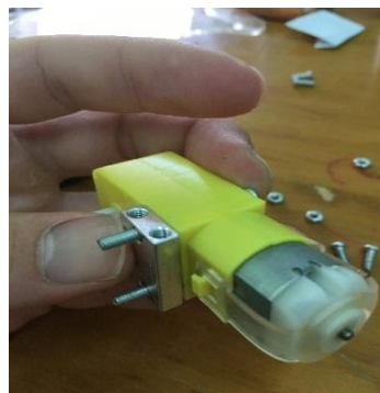
Εικόνα 5.7: Σύνδεση μοτέρ με ρόδες (Γ)
