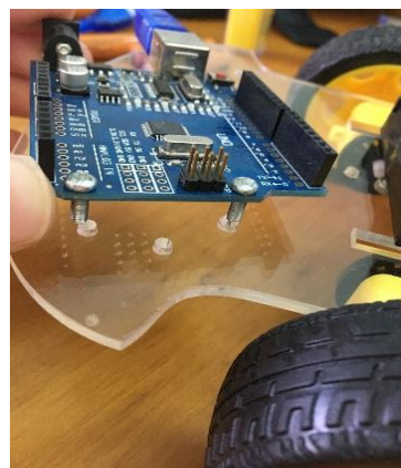
Εικόνα 5.20: Σύνδεση πλακέτας Arduino Uno με την βάση του οχήματος
