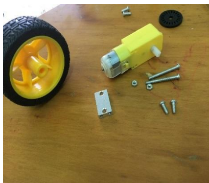
Εικόνα 5.5: Σύνδεση μοτέρ με ρόδες (Α)
