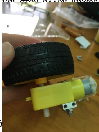
Εικόνα 5.9: Σύνδεση μοτέρ με ρόδες (Ε)
