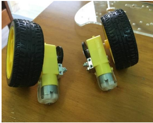
Εικόνα 5.11: Σύνδεση μοτέρ με ρόδες στην βάση (Α)
