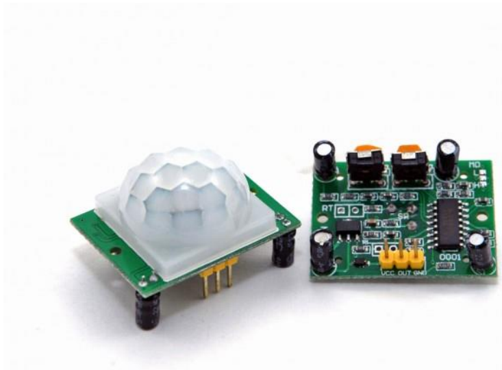
Εικόνα 17. Παθητικός αισθητήρας υπέρυθρης ακτινοβολίας
