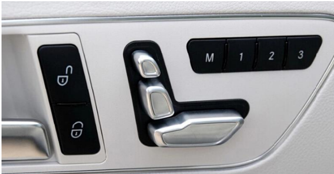
Εικόνα 5.5. Χειριστήριο της ηλεκτρικής ρύθμισης ενός καθίσματος αυτοκινήτου. Παραπέμπει το ίδιο σε ένα κάθισμα.
