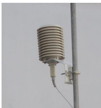
Εικόνα 68 Αισθητήρες θερμοκρασίας και σχετικής υγρασίας αέρα σε προστατευτικό κλωβό.
