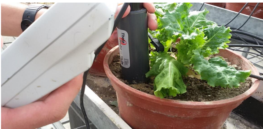
Εικόνα 16 Μέτρηση υγρασίας υποστρώματος με το ΔΤ ThetaProbe
