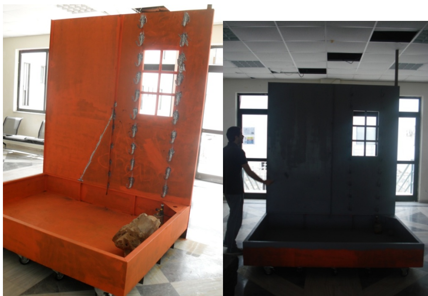
Εικόνα 13 βάψιμο του μεταλλικού πλαισίου με μίνιο αριστερά κ με το τελικό χρώμα δεξιά
