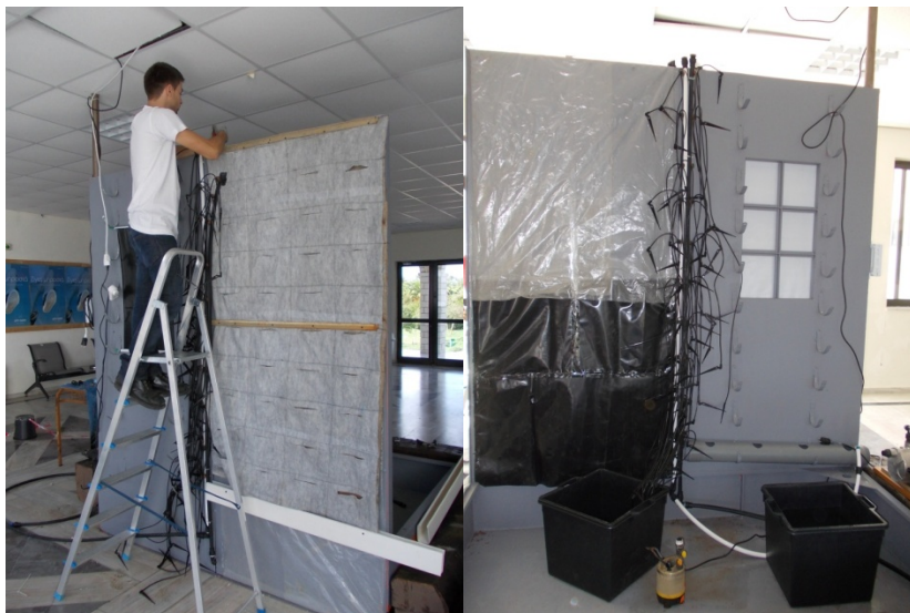
Εικόνα 18 Τοποθέτηση της τσόχας στο μεταλλικό πλαίσιο αριστερά κ πλαστικό φύλλο δεξιά
