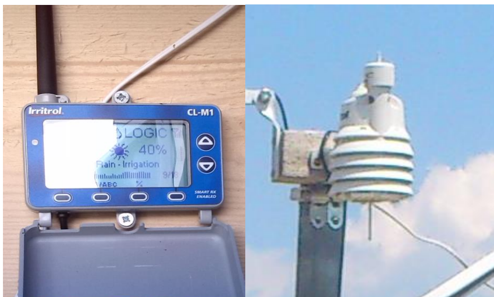
Εικόνα 21 Προγραμματιστής Rain Dial (εσωτερικός των 6 στάσεων) και σύστημα Climate Logic.
