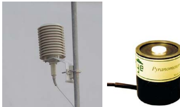
Εικόνα 59 Αισθητήρες θερμοκρασίας και σχετικής υγρασίας αέρα σε προστατευτικό κλωβό και πυρανόμετρο
