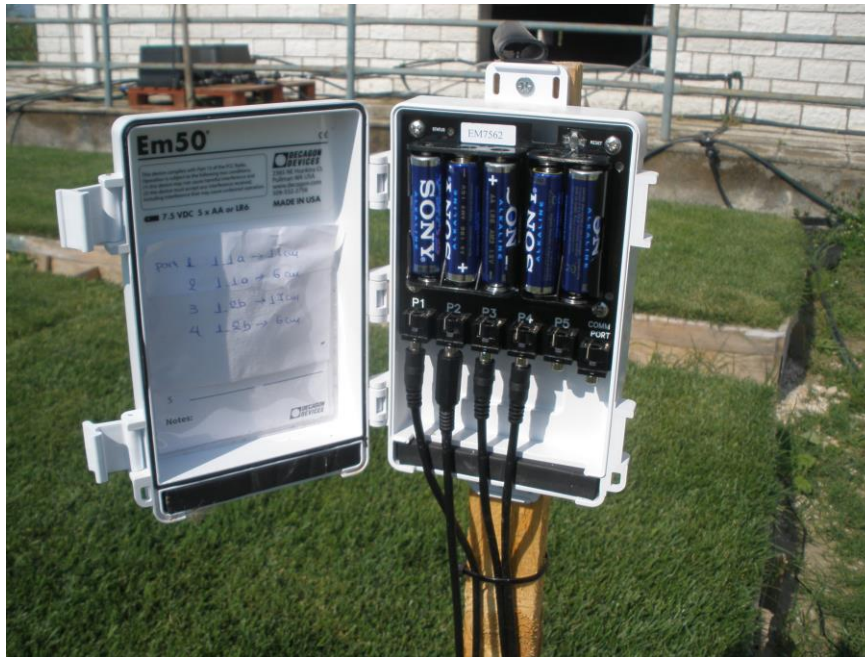
Εικόνα 22 Καταγραφικό (data logger) Decagon em50 με 4 αισθητήρες συνδεδεμένους
