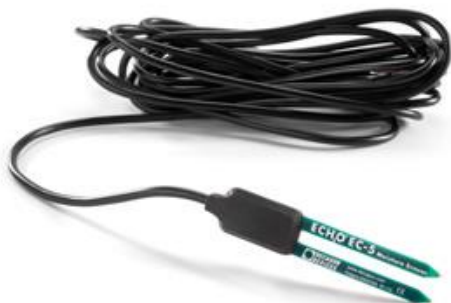
Εικόνα 37 Αισθητήρας ec5 και η σχετική περιοχή δείγματος
