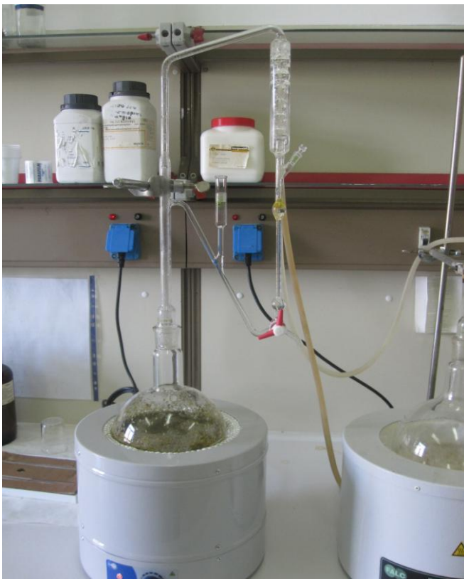
ΕΙΚΟΝΑ Ε3.1.5.: Αποστακτική συσκευή τύπου Clevenger Α΄
