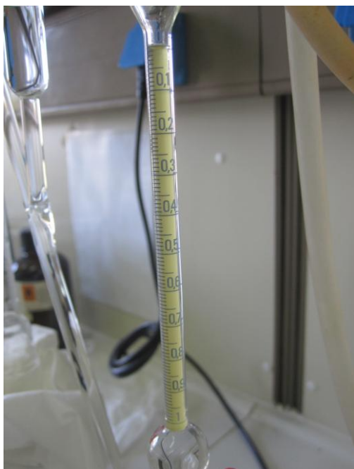
ΕΙΚΟΝΑ Ε3.2.: Σημείο μέτρησης αιθέριου ελαίου στην αποστακτική.
