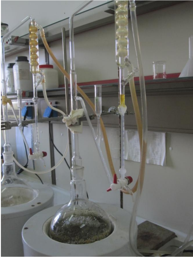
ΕΙΚΟΝΑ Ε3.1.4.: Αποστακτική συσκευή τύπου Clevenger Β΄
