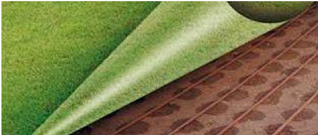
Εικόνα 1 Τυπικό σύστημα μικροάρδευσης έργου πράσινου με σταλακτηφόρους σωλήνες (επάνω) και υπόγειο σύστημα με σταλακτηφόρους σωλήνες για άρδευση χλοοτάπητα (κάτω)
