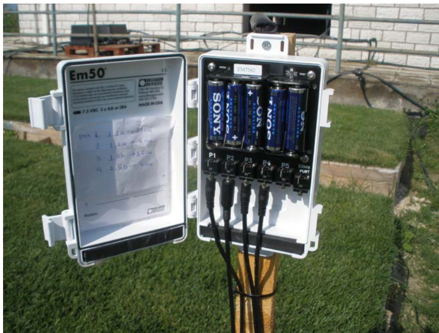
Εικόνα 17 Καταγραφικό (data logger) Decagon em50
