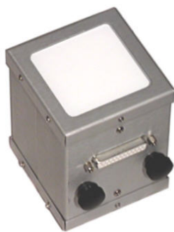
Εικόνα 24 Φορητό πολυφασματικό ραδιόμετρο CropScan
