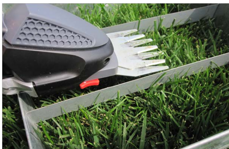
Εικόνα 19 Δειγματοληπτική κοπή χλοοτάπητα
