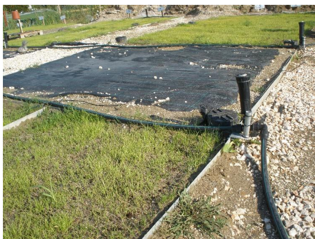
Εικόνα 15 Άποψη της πειραματικής διάταξης με τους εκτοξευτήρες Hunter MPR2000
