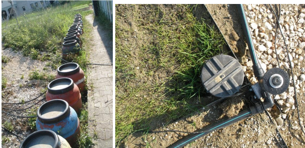
Εικόνα 23 α) Τα βαρέλια απορροής β) Το σημείο που ξεκινούσε το λάστιχο απορροής του plot και κατέληγε στο αντίστοιχο βαρέλι απορροής
