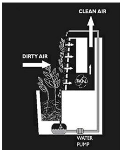
Εικόνα: 3.7. Μηχανισμός φυτικού τοίχους βιοφίλτρο
