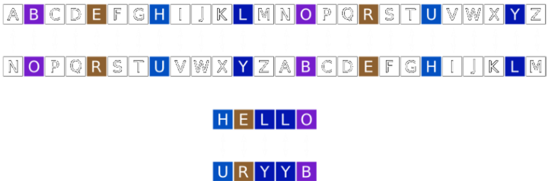
Εικόνα 16 - Παράδειγμα λειτουργίας CeaserCipher {Πηγή: http://datagenetics.com/blog/july42015/index.html }
