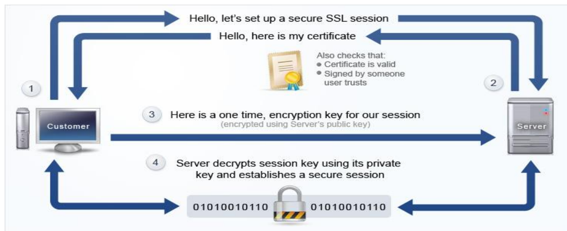
Εικόνα 27 - Υβριδική κρυπτογράφηση – SSL {Πηγή: https://www.awardspace.com/ssl-certificates/what-is-ssl-certificate }
