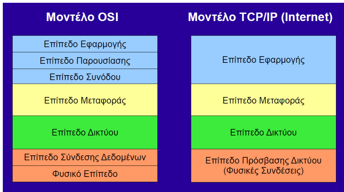
Εικόνα 2 - Μοντέλο OSI vs Μοντέλο TCP/IP {Πηγή: http://docplayer.gr/10016887-Kefalaio-7-7-1-7-4-e-p-a-n-a-l-i-ps-i-epikoinoniako-ypodiktyo-tcp-udp-sel-220-241.html }
