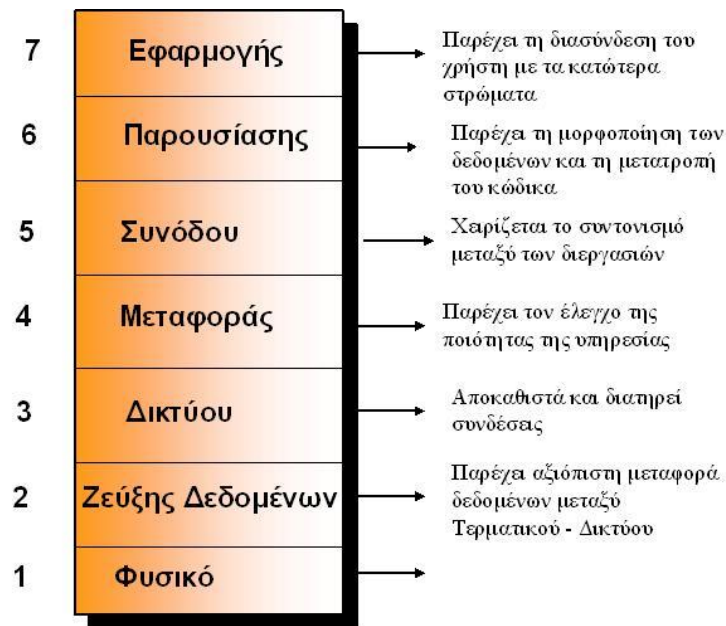
Εικόνα 1 - Επίπεδα Μοντέλου OSI{Πηγή: http://panacea.med.uoa.gr }
