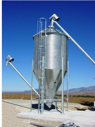
Μεταλλικά σιλό μείγματος
