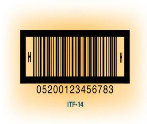
Εικόνα 8: Εμφάνιση του κωδικού INTERLEAVED 2 OF 5 ή ITF-14
