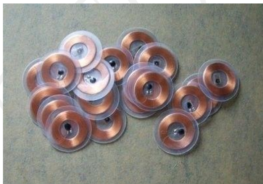
Εικόνα 21: Ενσωματωμένο RFID σε σχήμα δίσκου
