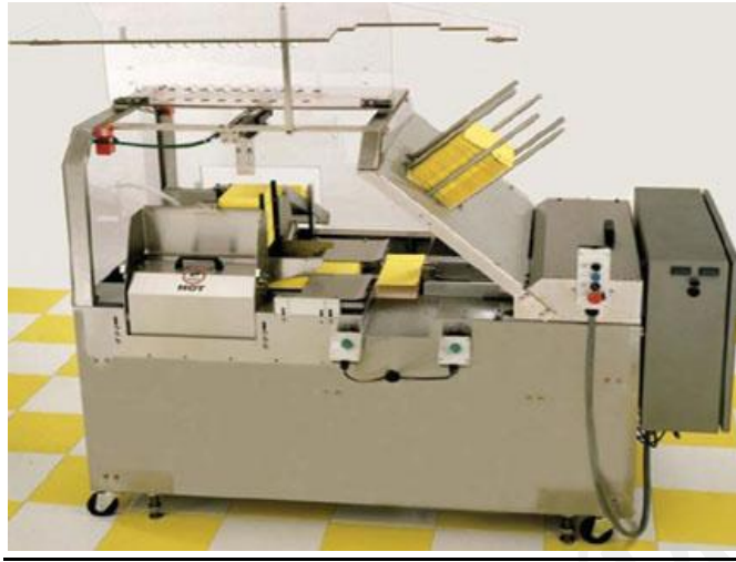
Εικόνα 30: Αυτόματη μηχανή τοποθέτησης προϊόντος σε κουτί κάθετης ή πλευρικής φόρτωσης. Κλείσιμο του κουτιού με δίπλωμα ή κόλλημα.
