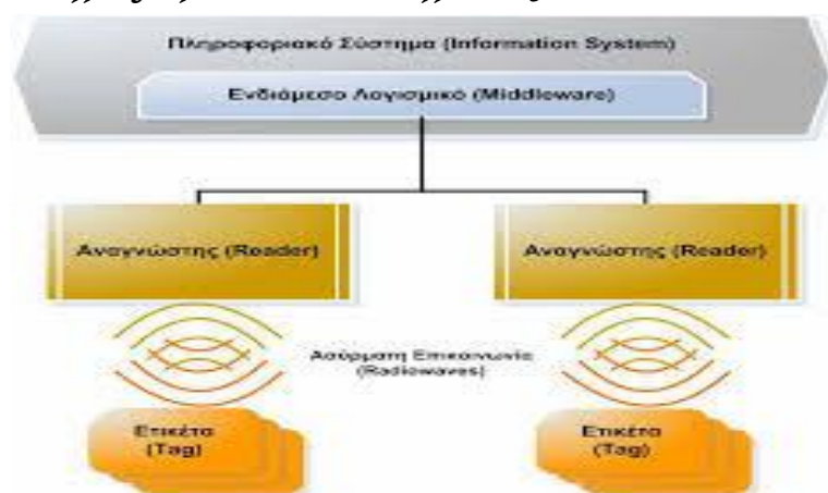
Εικόνα 29: Πώς γίνεται η λειτουργία του λογισμικού για τον αναγνώστη και την ετικέτα
