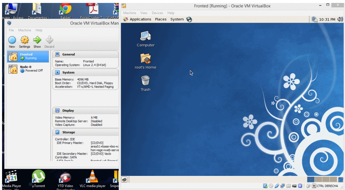
Εικόνα 4.30 Το VirtualBox Machine (αριστερά) μαζί με την επιφάνεια εργασίας Rocks Cluster v.5.4.3 viper (CentOs 5).
