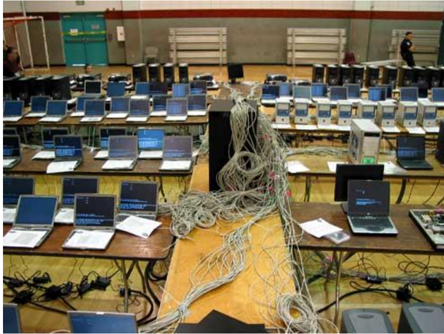
Εικόνα: 2.2 Flash Mob computing από 256 εθελοντές με τους προσωπικούς τους υπολογιστές, Laptop & Desktop συνέθεσαν ένα cluster computer στο πανεπιστήμιο του San Francisco.
