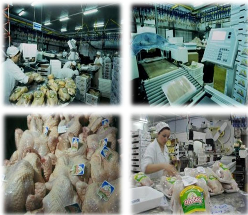
Εικ.28. Σύγχρονα συστήματα ζύγισης μέσω ηλεκτρονικών υπολογιστών
