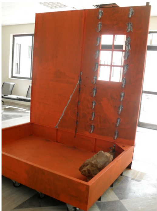
Εικόνα 34: Βάψιμο του μεταλλικού πλαισίου με μίνιο
