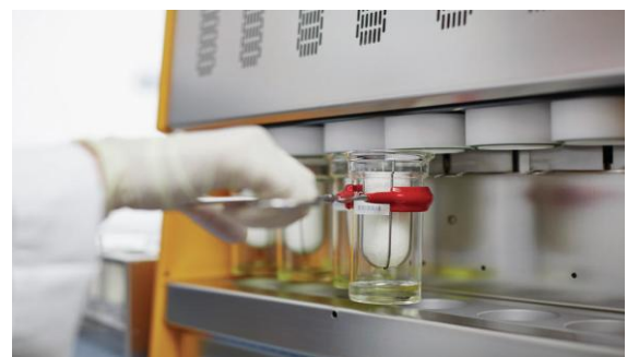
Εικόνα 4.1.4.4: Αφαίρεση ποτηριών μετά το τέλος της εκχύλισης
