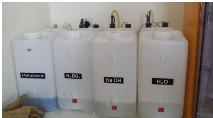
Εικόνα 4.1.3.7: Δοχεία εισαγωγής χημικών ουσιών και αποθήκευσης των λυμάτων της συσκευής Varodest 40
