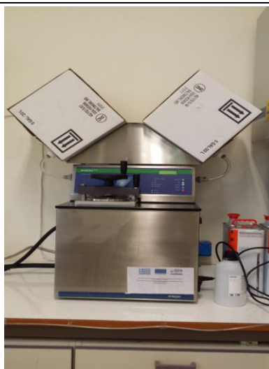
Εικόνα 4.1.7.1: Συσκευή ANKOM για τον προσδιορισμό ADF, NDF και λιγνίνης
