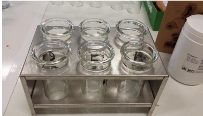
Εικόνα 4.1.4.1: Ειδικά ποτήρια ζέσεως της συσκευής Soxtherm
