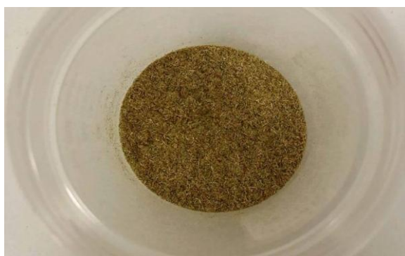
Εικόνα 4.2.2: Χονδροειδής ζωοτροφή μετά από ξήρανση και άλεση (μύλος kinematica polymix σχήμα 2)
