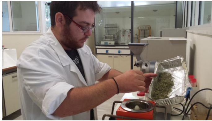
Εικόνα 4.2.7: Τοποθέτηση ζωτροφής προς άλεση στο μύλο Knifetec 1095
