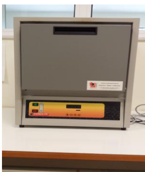
Εικόνα 4.1.2.1: Κλίβανος για την τοποθέτηση καψών στους 500-600° C
