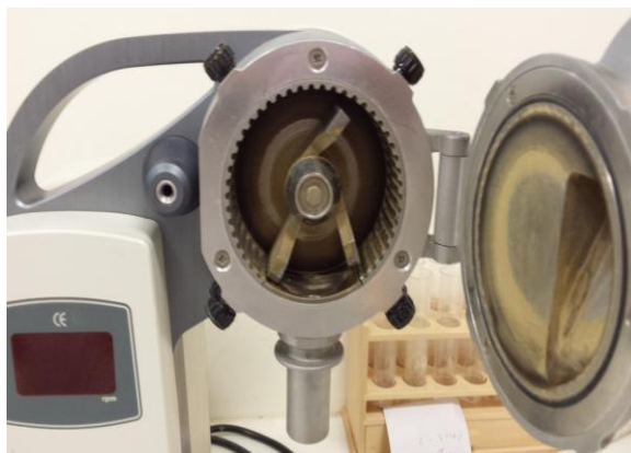
Εικόνα 4.2.3 : Εσωτερικό του μύλου Kinematica Polymix
