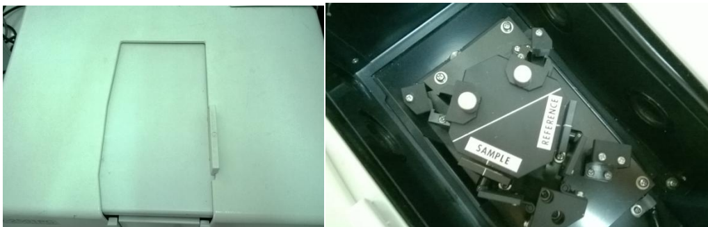
ΕΙΚΟΝΑ 14: 'πορτάκι' (αριστερά) και εσωτερικό Φασματοφωτόμετρου (δεξιά) με διάταξη σφαίρας ολοκλήρωσης
