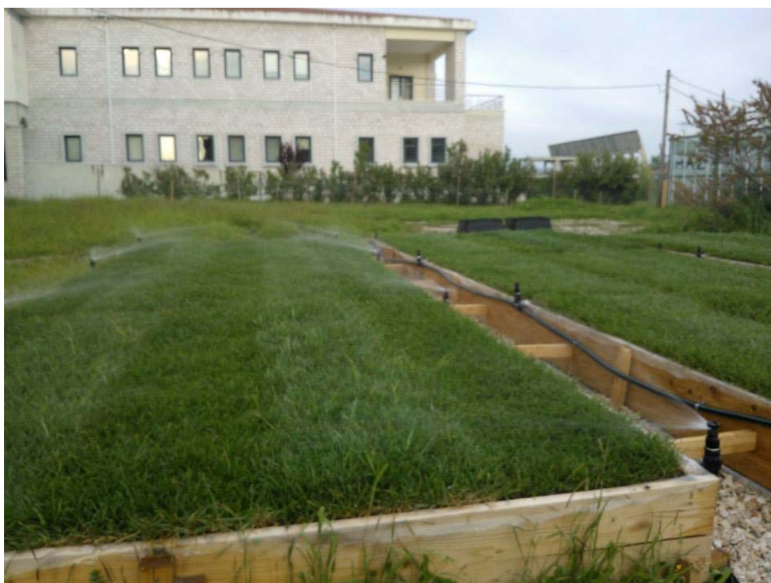
Εικόνα 2 Σύστημα τεχνητής βροχής σε πειραματικό τεμάχιο
