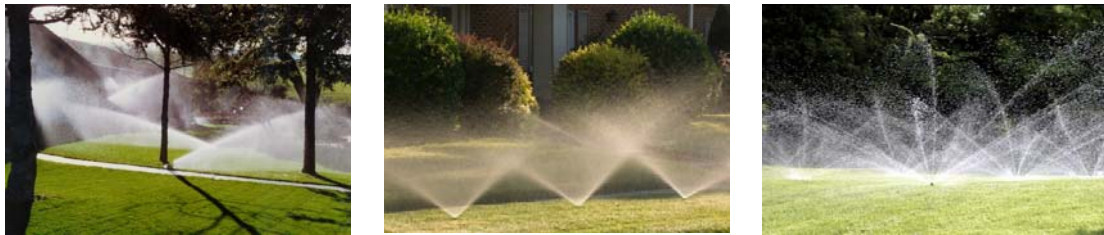
Εικόνα 3 Από αριστερά προς τα δεξιά: περιστροφικοί, στατικοί και πολυακτινικοί εκτοξευτήρες
