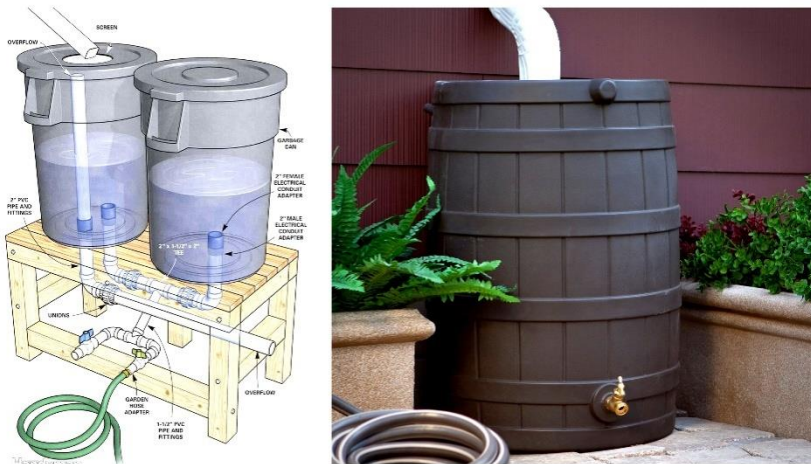
Εικ 59: Δεξαμενές αποθήκευσης του νερού της βροχής/των όμβριων υδάτων 94
