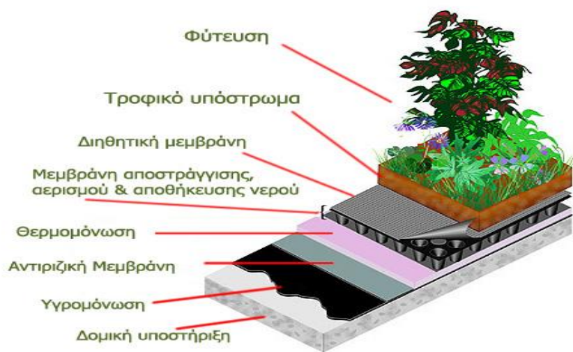
Εικ 53:Αξονομετρική άποψη φυτεμένου δώματος 83
