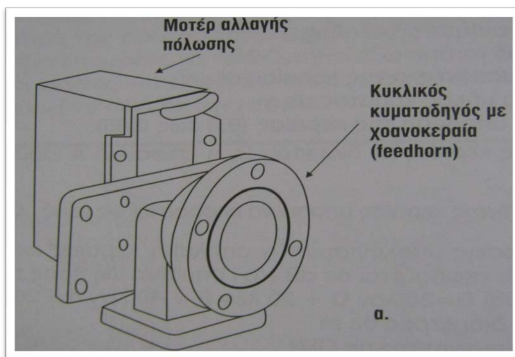
Μπλοκ πολωτή με FEEDHORN
