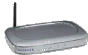
Μια τυπική συσκευή Access Point
