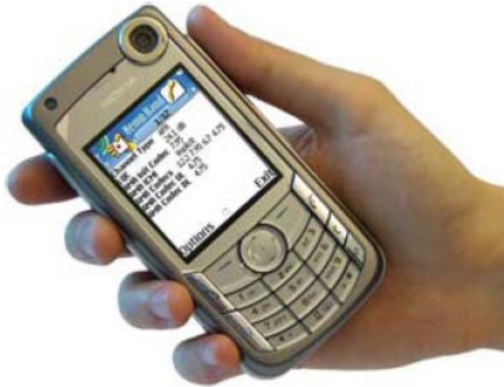
Σχήμα 5. Η συσκευή Nemo Handy με την οποία πραγματοποιήθηκαν οι μετρήσεις του QoS.
