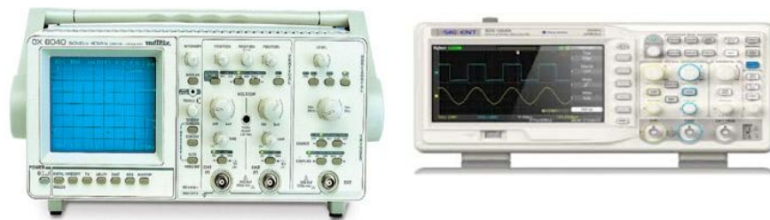
Εικόνα 3.2: Αριστερά απεικονίζεται ο απλός παλμογράφος και δεξιά ο παλμογράφος με μνήμη.
