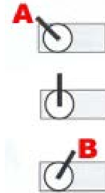
Εικόνα 7. Κίνηση του σέρβο
