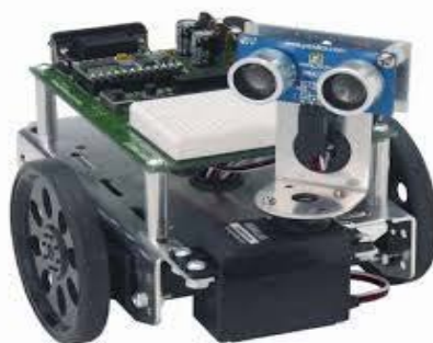
Εικόνα 17. Τηλεκατεθνομενο όχημα με υπερηχητικό αισθητήρα (supersonic sensor) της Parallax.
