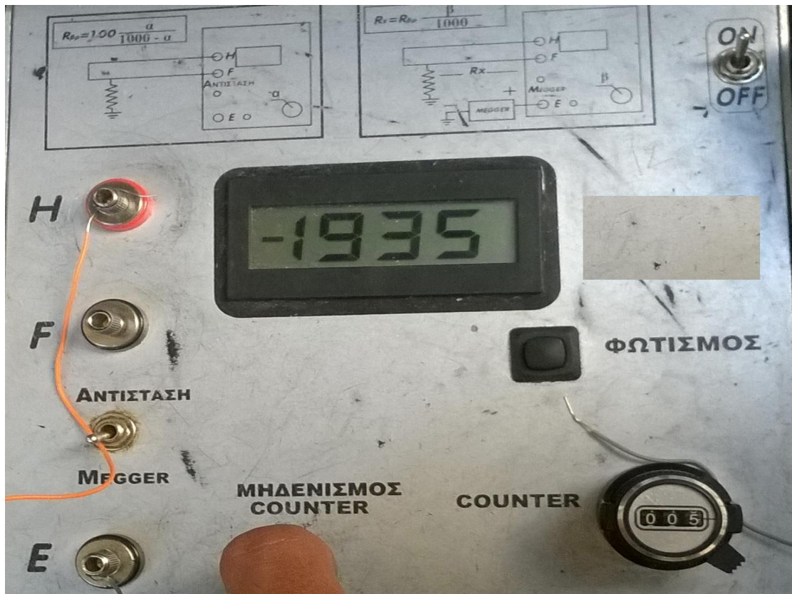
Εικόνα 12: Μέτρηση με υψηλή τιμή γείωσης.
