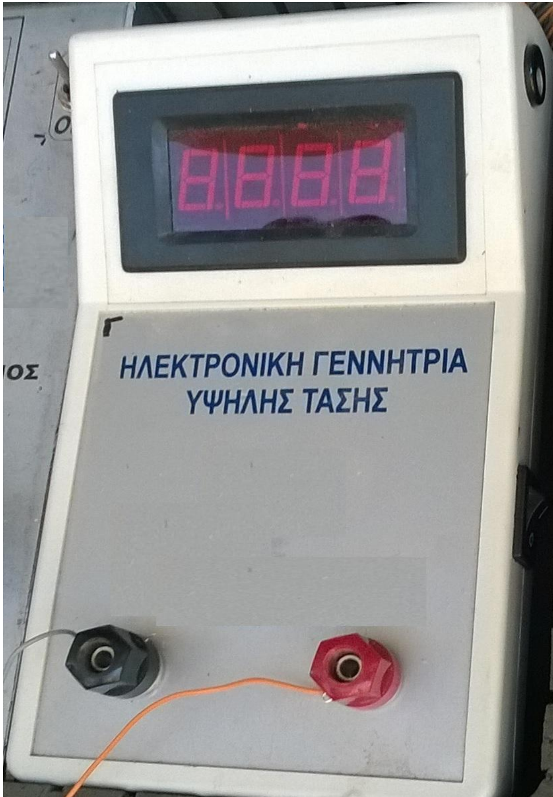
Εικόνα 15: Ηλεκτρονική γεννήτρια υψηλής τάσης.
