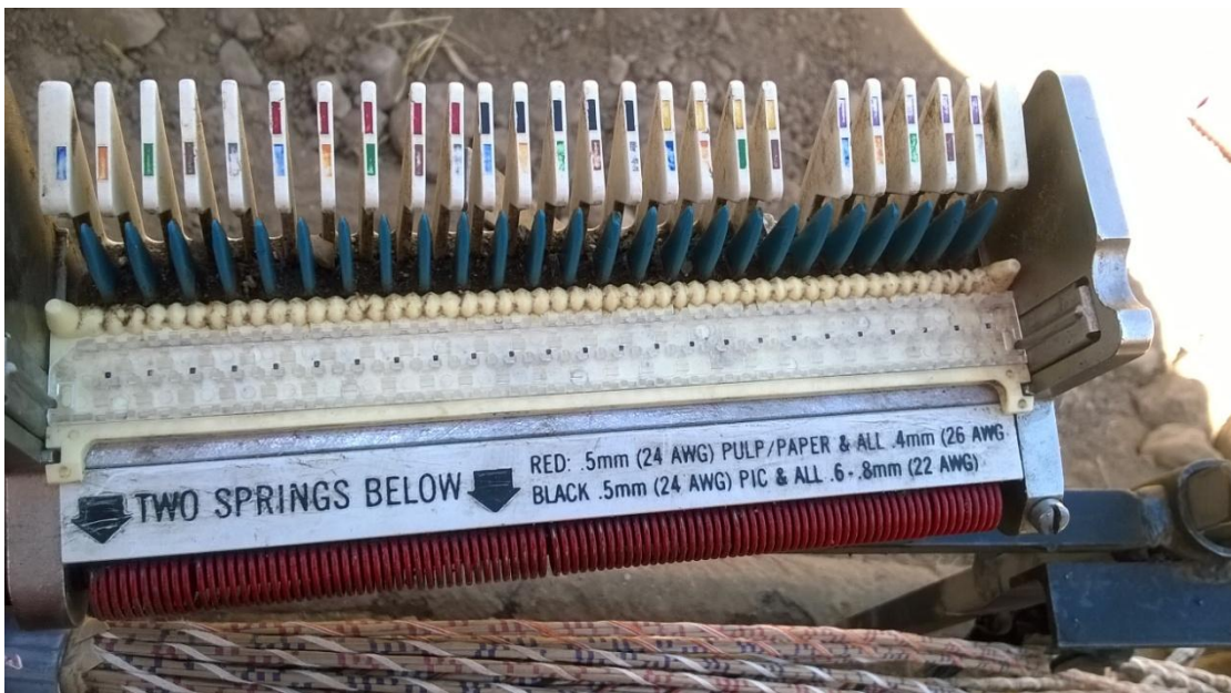
Εικόνα 38: Τοποθέτηση του κάτω μέρος της ένωσης πάνω στο χτένι.
