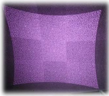
Εικόνα 5 Δομή Υπερύθρων από Πομπό Kinect[H20]
