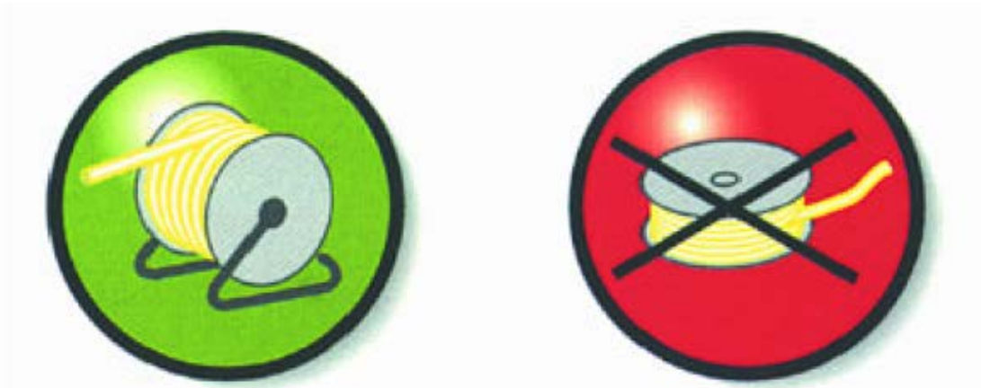
Σχήμα 27. Σωστός και λάθος τρόπος ξετυλίγματος καλωδίου
