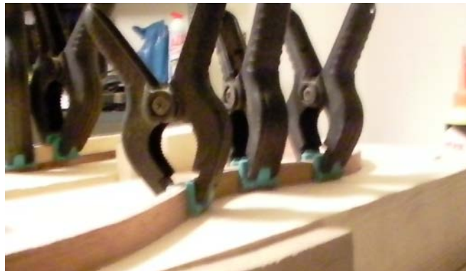
Εικ. 13. Κόλληση πατούρων
