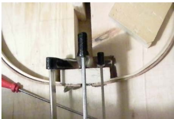
Εικ. 12. Κόλληση τάκων
