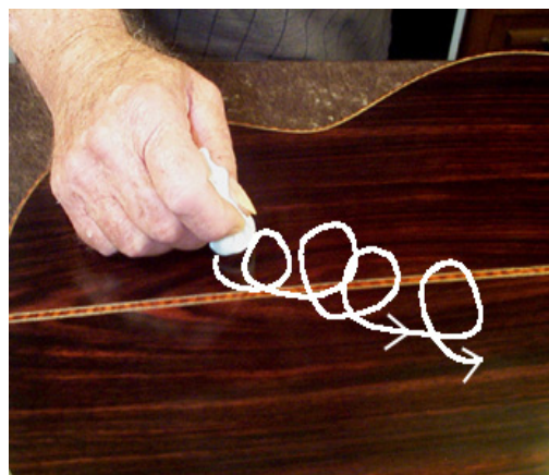
Εικ. 40. Πέρασμα γομαλάκας - κυκλικές κινήσεις
