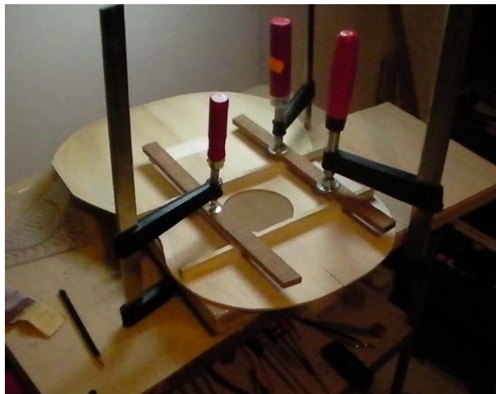
Εικ. 18. Τοποθέτηση και κόλληση καμαριών
