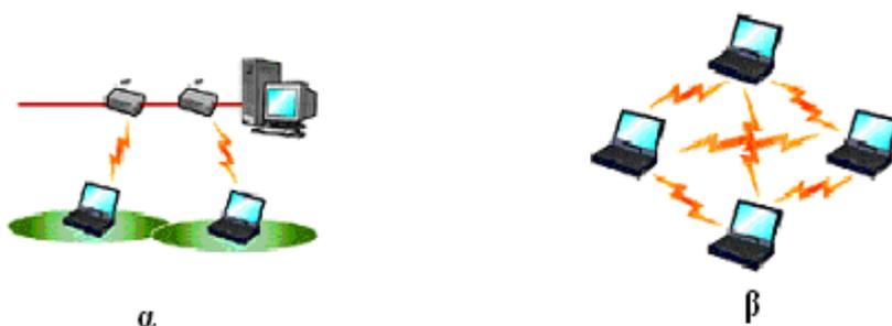
**Σχήμα 1:** (α) Κανάλι από σημείο σε σημείο ( point to point channel) (β) Κανάλι πολλαπλής προσπέλασης (multiple access channel).
