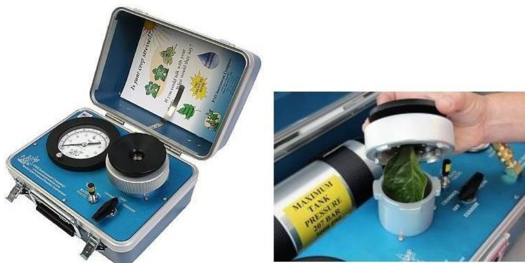
Εικόνα 9: Συσκευή μέτρησης υδατικού δυναμικού φύλλων
