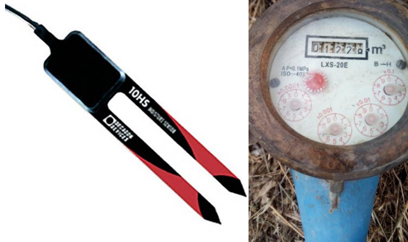
Εικόνα 38: Αισθητήρας τύπου 10HS, METER Group, Inc. και υδρόμετρο ακρίβειας 1L, τύπου DS-TRP, Madalena S.P.A., Italy
